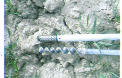
Tensiomètre Watermark® et son outil de pose (tarière villed)
