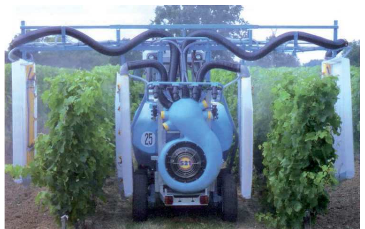
PULVERISATION S21 tunnel de pulvérisation
