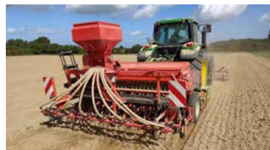
Semoir à double caisson / (mécanique + pneumatique) (crédit photo : Ferme expérimentale de Thorigné d'Anjou)
