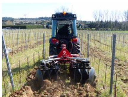
Cover-crop avec disques en position droite
