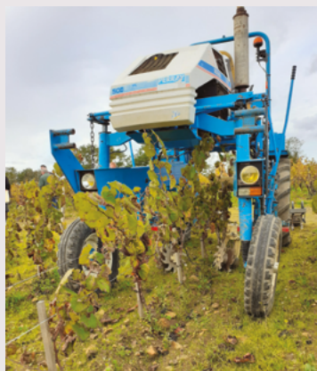
Vignes étroites : disques émotteurs et bêche à doigts Kress
