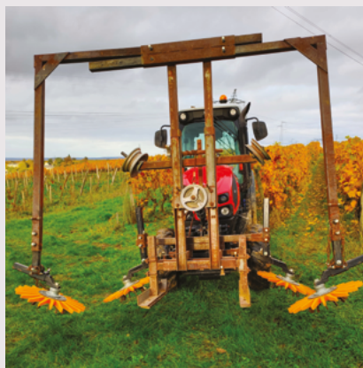
Vignes larges : bêche à doigts Kress (outil maison) et trains de disques émotteurs
