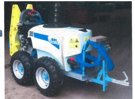
S21 - Voûte droite petite turbine 300 autonome
