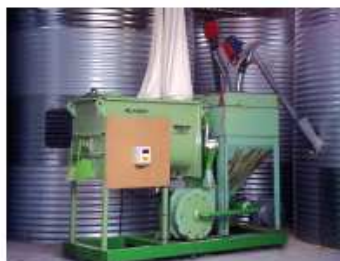
Une FAF complète : stockage-broyeur ventilateur-mélangeur horizontal
