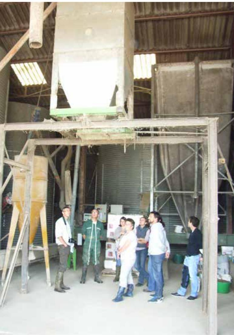
Une trémie surélevée permet un remplissage rapide de la mélangeuse
