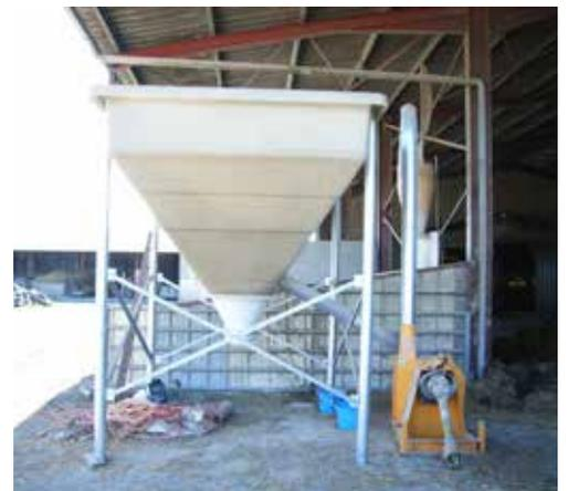
Lorsque le stockage des céréales se fait à plat, le broyage peut se faire à l'aide d'un broyeur sur la prise de force d'un tracteur.
