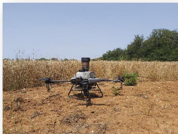
Le drone est équipé d'un **semoir à disque** avec un système de balance, qui permet de contrôler la qualité de semis. La densité de semis est, quant à elle, contrôlée par l'ouverture plus ou moins grande de la sortie du réservoir.
