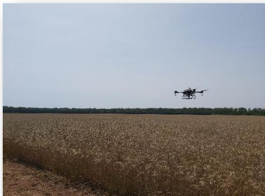
La capacité d'épandage du drone est de 6 m de large à 3 m de hauteur. Il utilise un plan de vol pour se diriger. Il avance, en moyenne, à 20 km/h. Sa vitesse varie en fonction du nombre de graines à semer et donc de leur taille.
