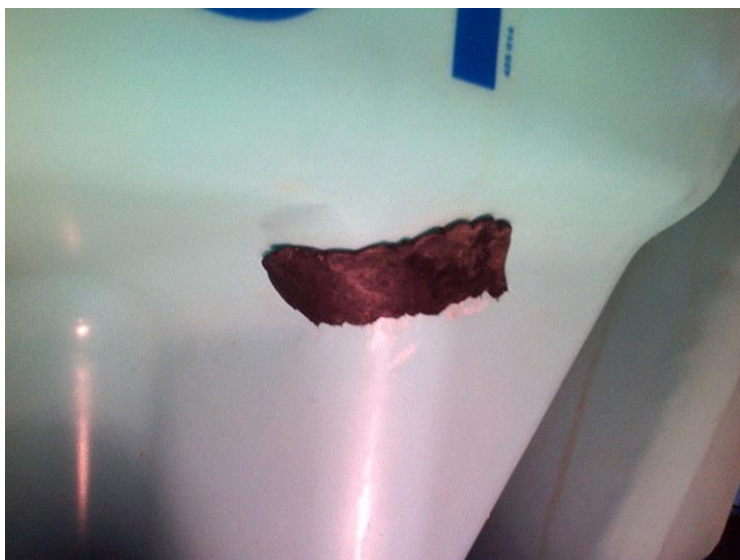
L'une des réparations effectuées sur la cuve du pulvérisateur
