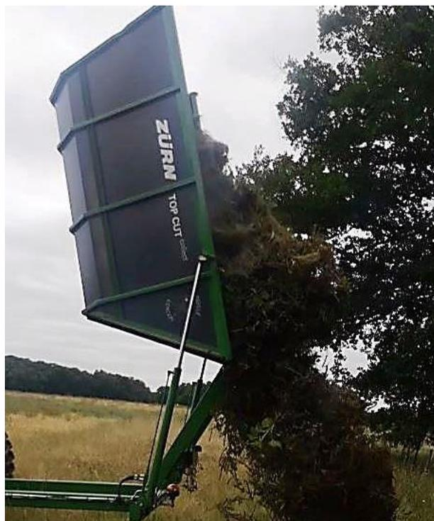
La trémie est basculante et d'une capacité de 6 m<sup>3</sup>
