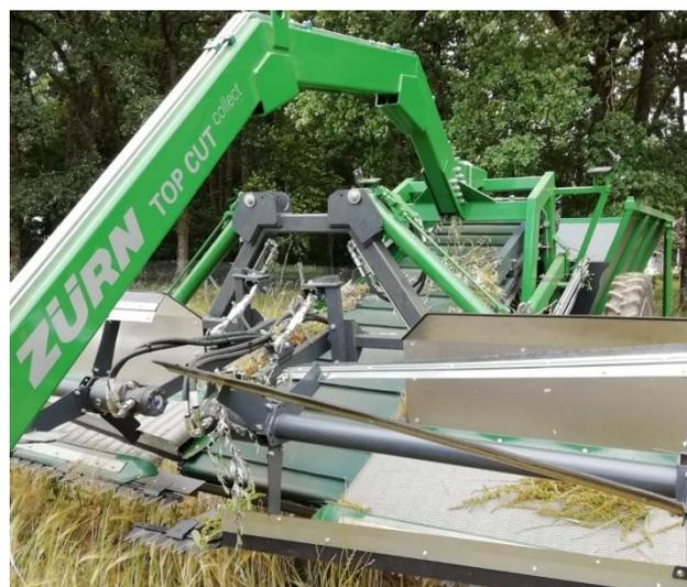
Les adventices sont coupées par un lamier à doubles lames lisses, un système de coupe durable et robuste, même sur des adventices avec de gros diamètres de tige.
