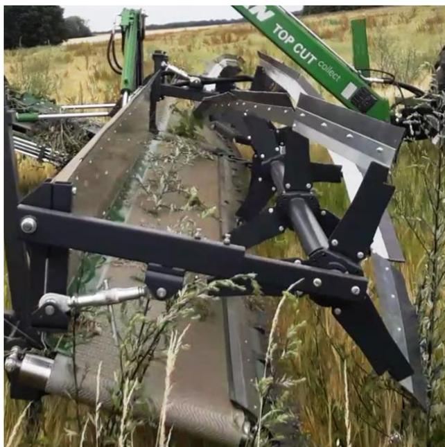
Les rabatteurs hélicoïdaux évitent aux tiges souples (par exemple des graminées) de se coucher et de passer sous la barre de coupe. Ils limitent la perte de la biomasse collectée sur le tapis.
