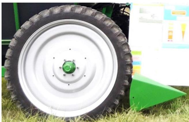
La voie de la machine est réglable et s'adapte à celle du tracteur. Des diviseurs sont installés devant les roues. Ce système de diviseur est également adaptable devant les roues avant du tracteur afin de limiter l'écrasement de la culture et des adventices à sectionner.
